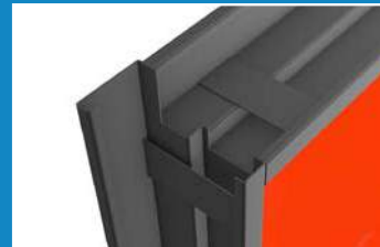
İç Kasa Duvara Sabitleme Aparatı Door Frame Fixing
